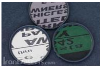
لنز سمت چپ بدون پوشش - لنز بالا دارای یک لایه پوشش - لنز سمت راست دارای دو لایه پوشش
